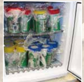
専用保温庫での養生
